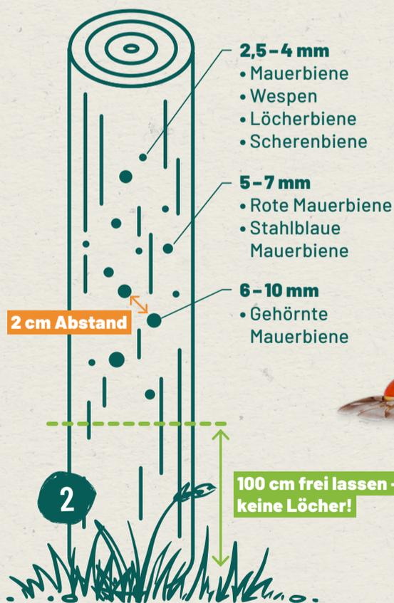
**Schritt 2** Mit verschiedenen Lochgrößen lockst du unterschiedliche Wildbienen an. Gestalte die Anordnung nach Belieben, aber achte auf genügend Abstand und darauf, die Löcher nicht zu nah am Boden zu bohren, damit sie nicht von hohem Gras verdeckt werden. Die Flugbahn muss stets frei bleiben.
