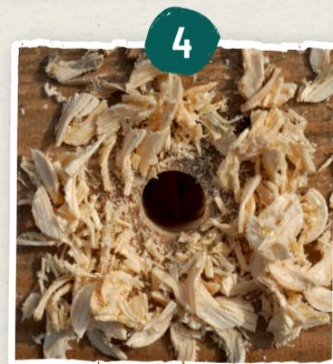
**Schritt 4** Bewege den Bohrer so lange hin und her, bis alle Splitter entfernt sind. Sollten danach noch Splitter abstehen, entferne sie mit Schleifpapier. Die Löcher müssen glatt sein, damit sich die Insekten nicht verletzen. Entferne alle Holzreste, indem du gegen die Rückseite des Pfahls klopfst.
